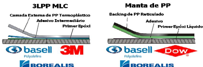
**Figura 6.** Revestimentos de planta e de juntas de campo. Matérias-primas.
