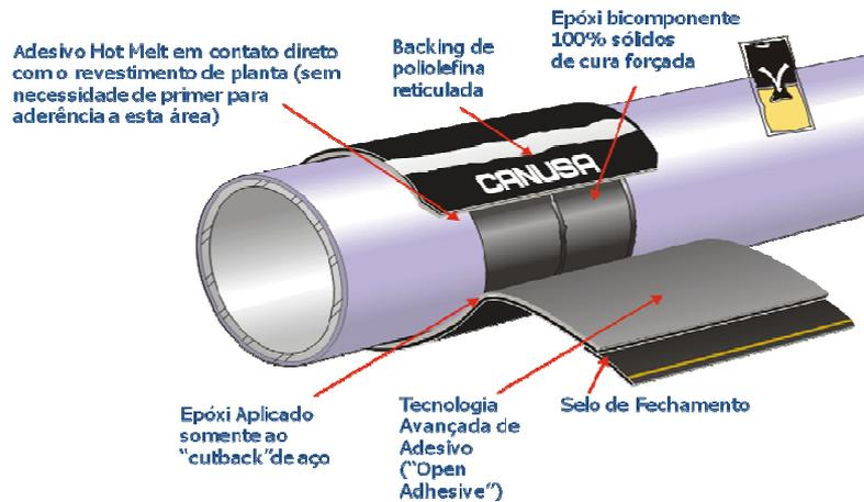
**Figura 4.** Esquema para um sistema tripla camada de mantas termocontráteis
