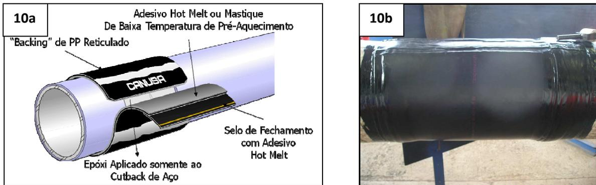
**Figura 10a.** Esquema de um sistema de mantas híbridas. **10b.** Foto de um sistema híbrido aplicado nas juntas de 16” de diâmetro de seção lançada em perfuração de “shore approach” no projeto Terminal Norte Capixaba.
