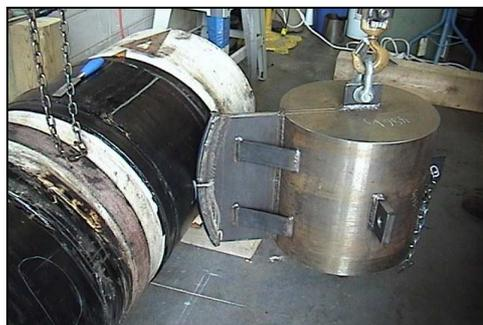
**Figura 11.** Ensaio de impacto aplicado a mantas com “backings” de polipropileno
